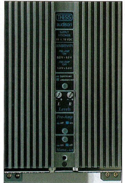
I controlli. Dall'alto in basso: deviatore bilanciato/sbilanciato, sensibilità, pre on/off, deviatore stereo/bridge.
