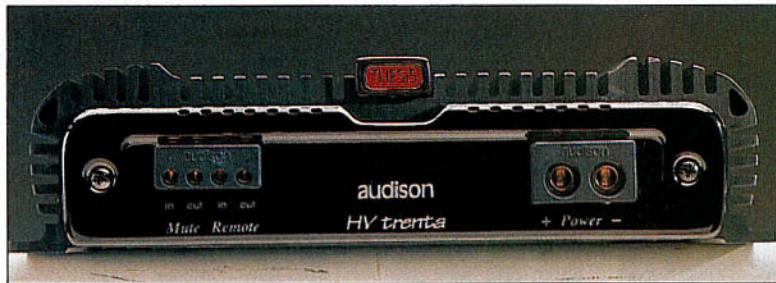
Sopra, i connettori di ingresso ABS, un brevetto Audison. Si tratta di connettori bilanciati formato RCA. A destra, le generose morsettiere di alimentazione.
