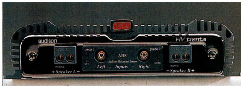
Sopra, i connettori di ingresso ABS, un brevetto Audison. Si tratta di connettori bilanciati formato RCA. A destra, le generose morsettiere di alimentazione.
