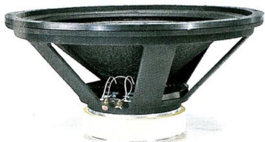
La vista laterale dell'Air 5400 ne mette in risalto la notevole complessione fisica e lo sviluppo generoso del cestello, che fa apparire addirittura piccolo il seppur grosso (ed efficientissimo) magnete. Il cestello è in lega leggera antirisonante ed è ricavato in gran parte per tornitura.
