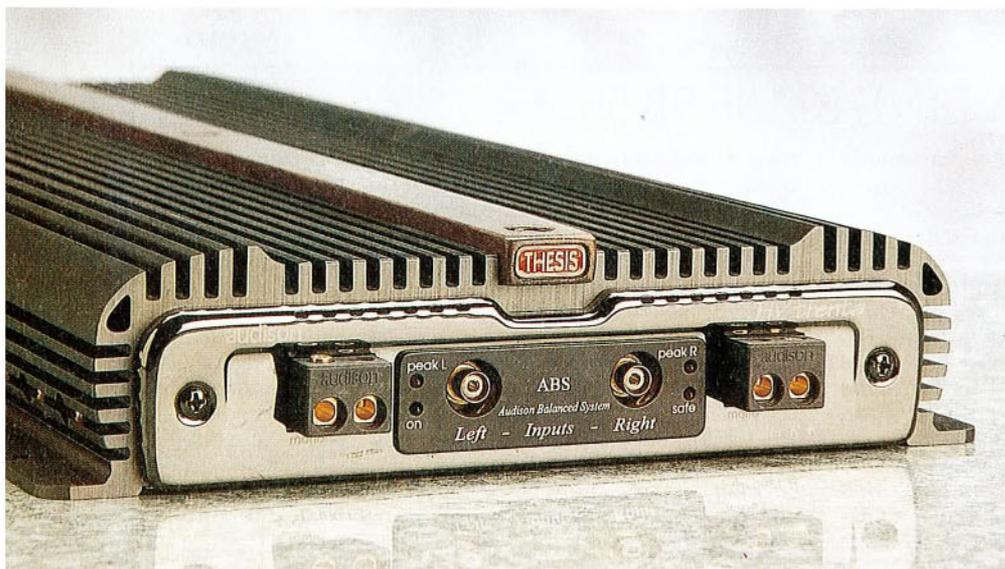
*Le connessioni sono tutte raccolte in questo pannello: si notano le prese in «standard» ABS ed i ben dimensionati morsetti di uscita.*
