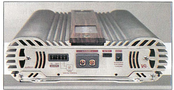
Il lato morsettiere di alimentazione. Ai lati, gli ingressi per l'aria forzata; notare l'originale conformazione a "triplo tunnel".
