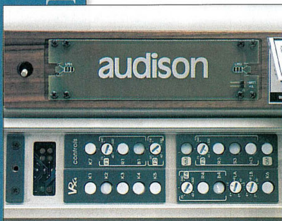
Primo piano degli elementi di controllo: filtri x-over, sensibilità, controllo di fase. C'è tutto quel che serve, e anche di più.
