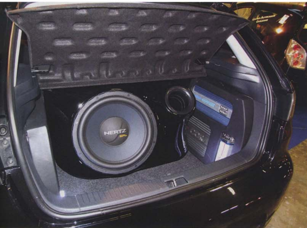
Grande box sagomato e rivestito in vetroresina nera e lucidissima che supporta il subwoofer Hertz HSX380 che riesce a combinare prestazioni da SPL con un basso sempre corretto e potente.
