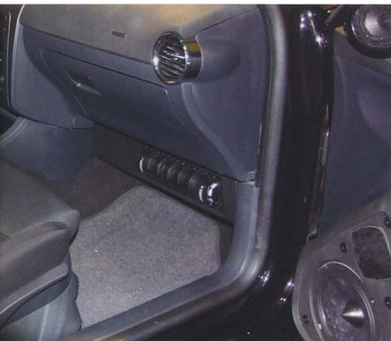
Poco invadente da un punto di vista estetico e dell'ingombro: spunta dalla parte bassa del cruscotto il profilo cilindrico del Tymphany LAT 250, utilizzato come subwoofer anteriore di rifinitura.
