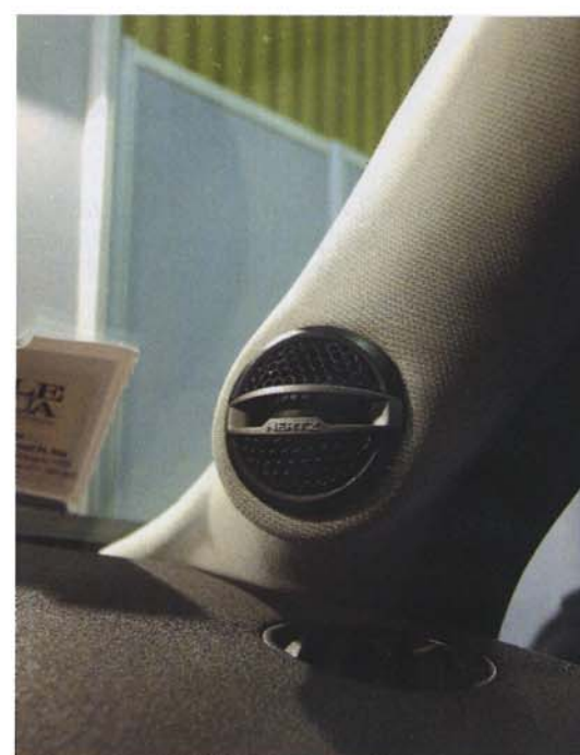
Dalla vista ravvicinata si può apprezzare meglio il lavoro di ricostruzione e rifinitura, entrambi di gran qualità, per ospitare ed angolare efficacemente il tweeter HT25.
